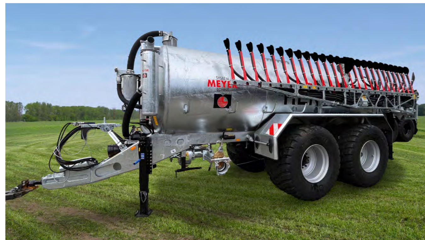
Vakuumentankwagen mit Schleppschuhverteiler und Sonderausstattungen
