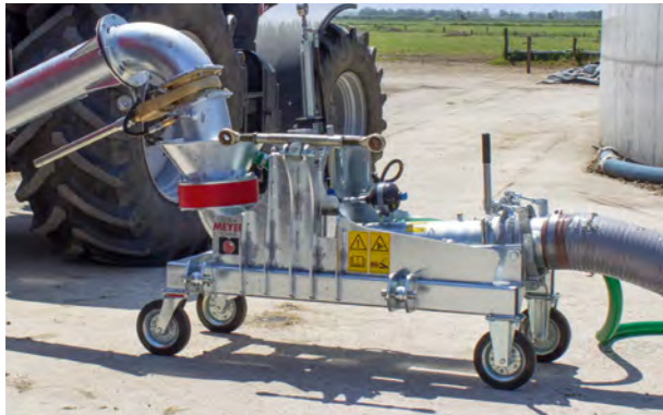
Mobile Andockstation AUTOMAX vereinfacht das Absaugen aus Gruben und Hochbehältern (gegen Aufpreis).
