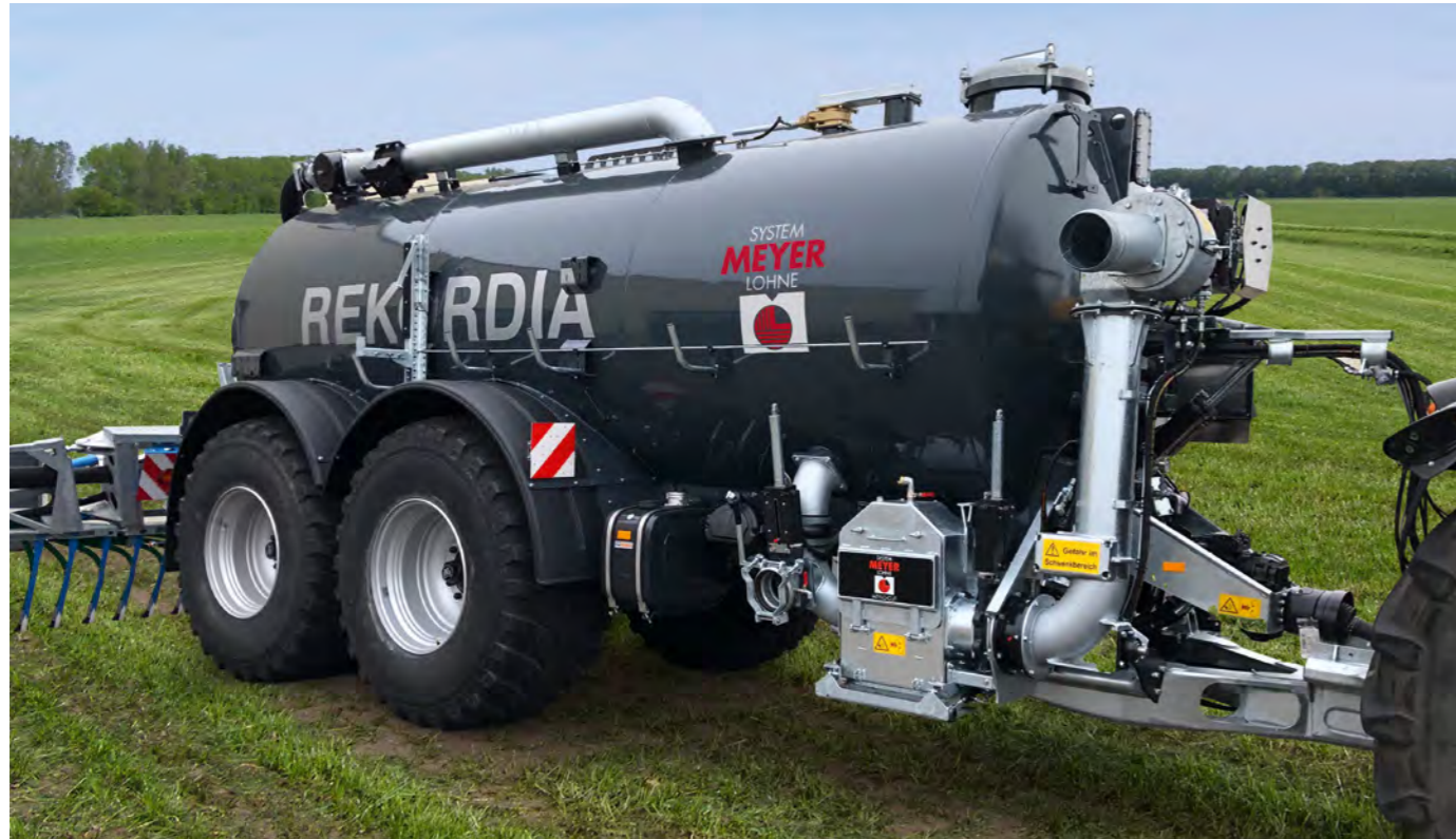
Pumptankwagen 20.000 Liter Tandem und Sonderausstattungen
