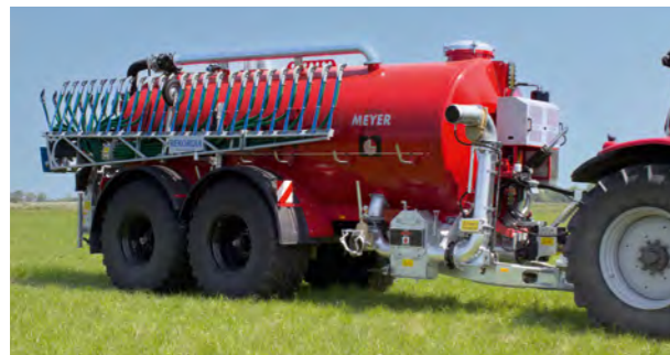
Pumptankwagen mit Farmer-Schleppschuh 15 m und Sonderausstattungen
