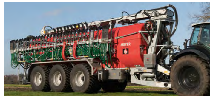
Pumptankwagen mit Flex-Saugarm, Slide-Schleppschuh 30 m und Sonderausstattungen
