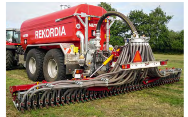
Grünland-Scheiben-Güleinjektor, Arbeitsbreite 5,7 bis 12 m.
