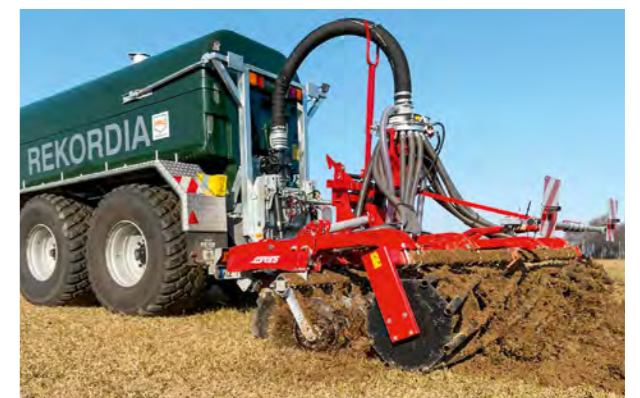
Evers Toric Zinkinjektor, Arbeitsbreite 4,5 bis 7 m.
