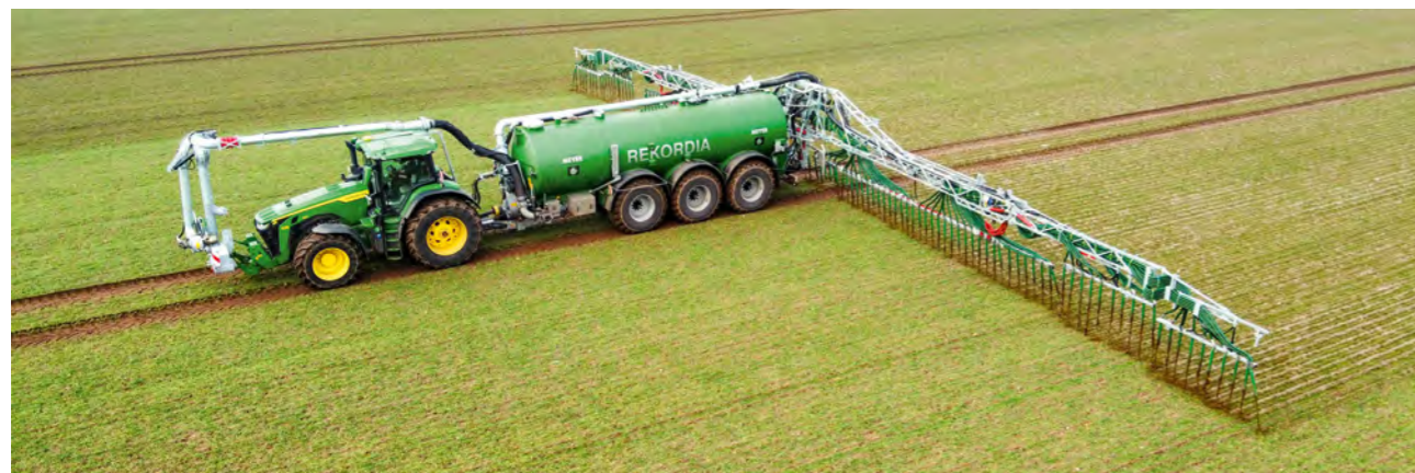
Schleppschlauchverteiler SWING MAX, Arbeitsbreite 12 bis 36 m.
