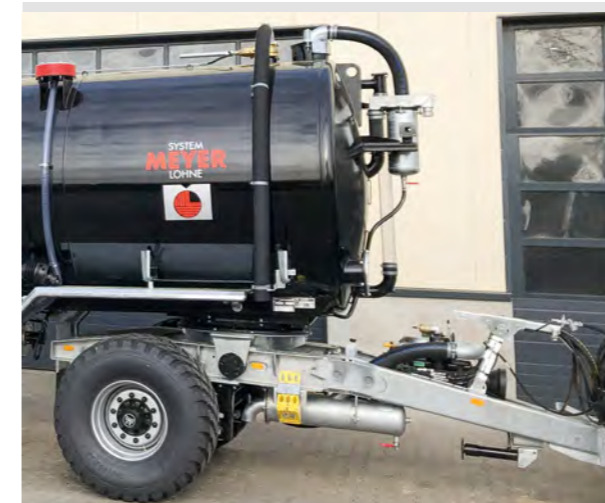
Drehschemel-Vorderachse für Vakuum-Transportanhänger
