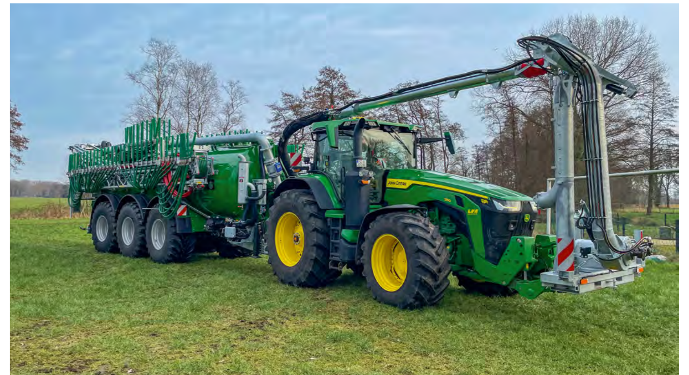
Kreisel-Pumptankwagen mit Frontsaugarm, Schleppschuh 30 m und Sonderausstattungen
