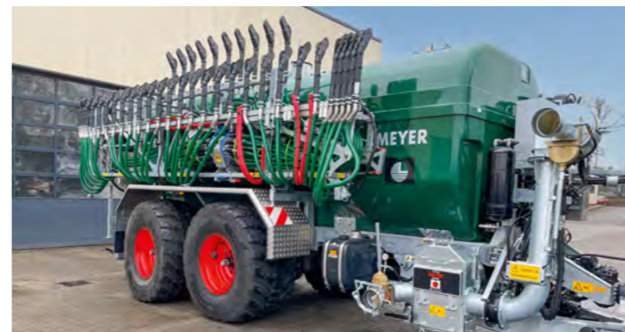
Pumptankwagen GFK mit Slide-Schleppschuh 24 m und Sonderausstattungen
