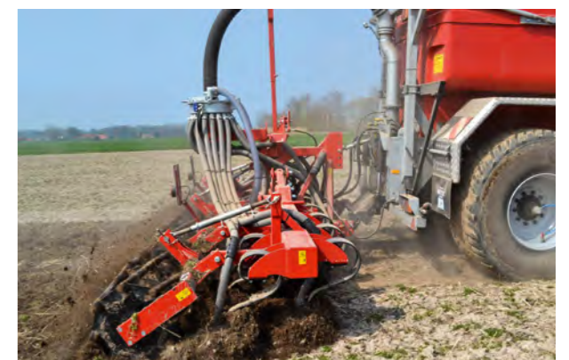
Ackerland-Zinkeninjektor, Arbeitsbreite 4,5 bis 7 m.
