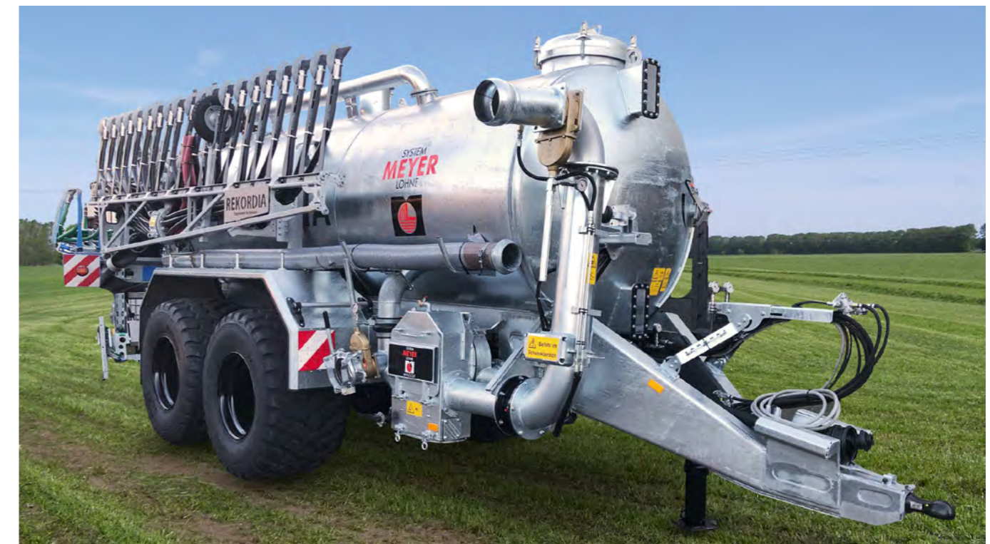
Pumptankwagen mit Schleppschuhverteiler und Sonderausstattungen
