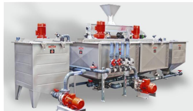
Futterzentrale Mastschweine Zu- und Abschlagfütter als Pendelanlage mit Wasser-Refresh-Programm
