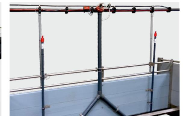
Langtrug mit Ventil und SMART 3 WIRE BUS für Zu- und Abschlagfütterung restriktiv
