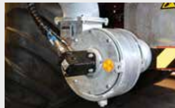
Saugbeschleuniger für höhere Saugleistung
