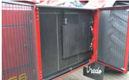
Kühler und Umkehrlüfter einfach zu reinigen, dadurch maximale Kühlkapazität
