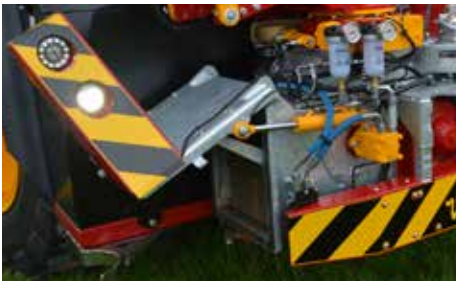
Schneidfilter mit automatischer Entleerfunktion aus der Kabine bedienbar
