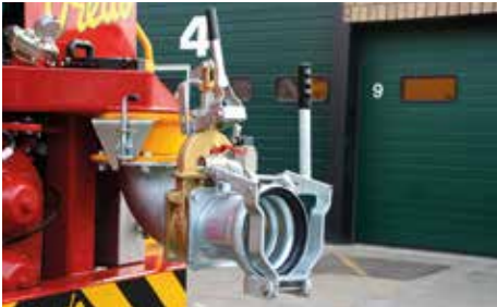
6" Anschluss drehbar. Beim Öffnen startet der Saugvorgang automatisch
