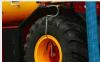
Reifendruckregelanlage für optimalen Reifendruck im Feld & auf der Straße
