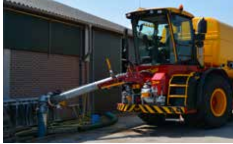
Saugrüssel 120° drehbar Blickfeld
