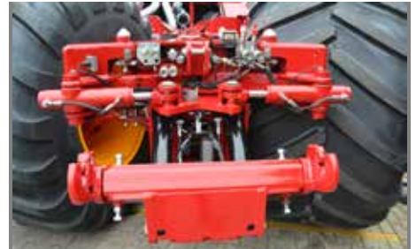
Hebevorrichtung mit aktiver Federung & Hundeganglenkung
