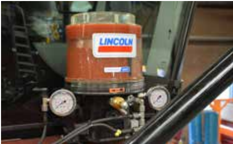
Serienmäßig automatische Schmieranlage für maximale Lebensdauer
