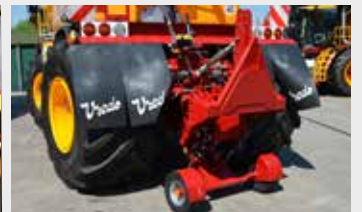
„Hilfsachse“ unter Hubwerk montiert, zur Erhöhung des zul. Gesamtgewichtes bei Selbstfahren
